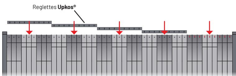
**4** Clipsez la lisse haute aluminium en deux parties, en veillant au sens de pose.
